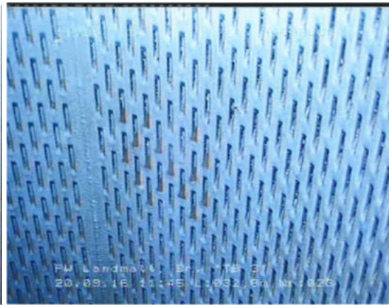
Bild Nr. 23 Tiefe: -32,8 m Im Filter, die Rohrwand ist relativ sauber; geringe Ablagerungen in den offenen Filterschlitz
